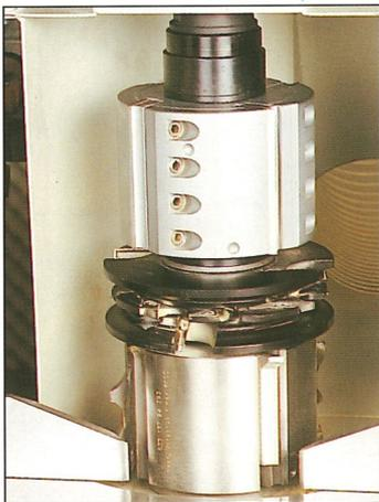
Hubspindel mit automatischer Steuerung der Hobhöhe und Vorwahl von Dicke und Breite. Beschleunigter Durchlauf in der Fertigung!
