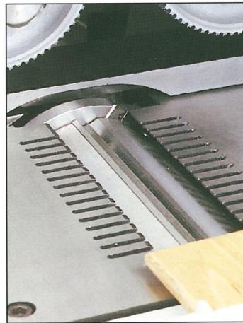
Abrihtspindel mit Falzfräser und geschlitzte Tischplatten: Präzision beim Abrihten und Fügen, Lärmschutz.
