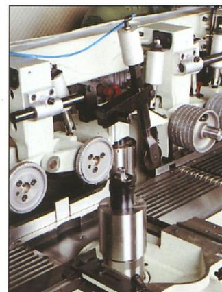
Nuten-Führsystem für gerade Fügekanten ergibt verleimfähige Werkstücke. Auch kurze, ungekappte Werkstücke werden parallel, auch verzogene genau abgerichtet, auch konische und geschwungene exakt dickengehobelt.
