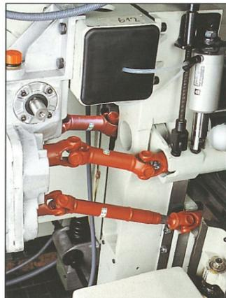
Antrieb durch Kardan gelenke, nicht mit Ketten: robuster, wartungsfrei, langlebiger, genauer.
