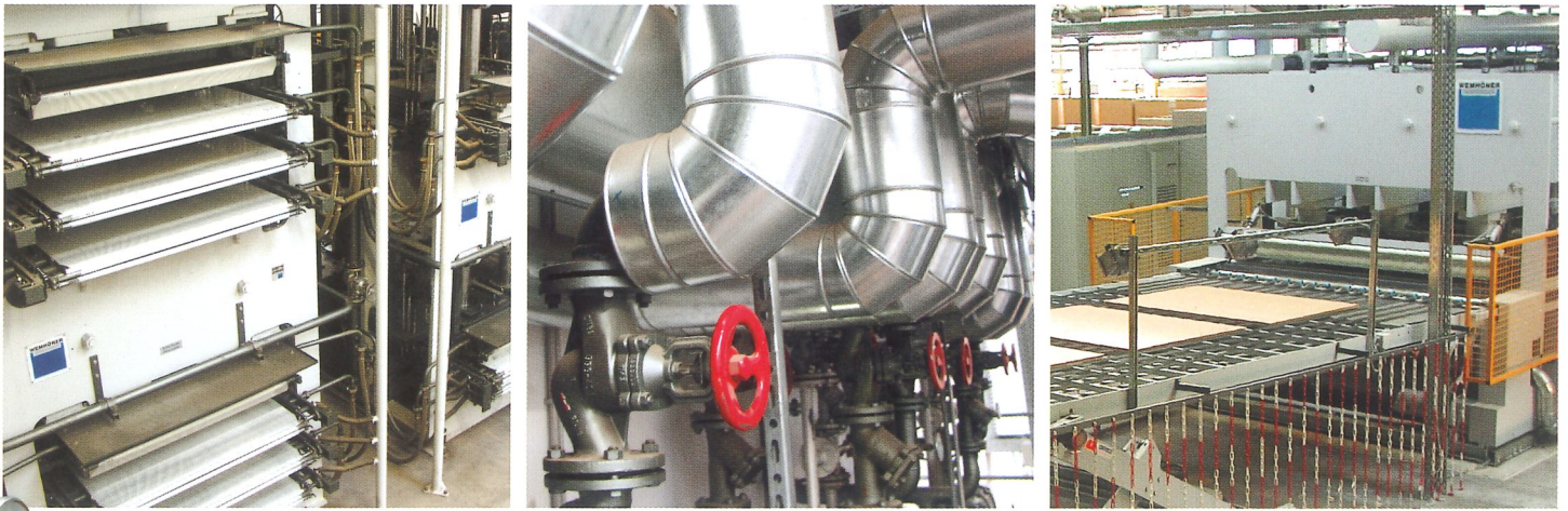
KI-V-ME für Türenproduktion | 2 x 3 Etagen: 2–6 | Pressfläche 2,8 m x 1,4 m | Jede Pressensektion ist einzeln zu steuern | Spezifischer Druck bis 200 N/m 2 | Temperatur: bis 130 °C
