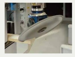
Das Sägesystem ermöglicht eine Vielzahl von Bearbeitungen (z.B. Schifter-, Kerven- und Längsschnitte).
