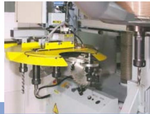
Mit dem Werkzeugmagazin steht Ihnen immer das richtige Werkzeug zur Verfügung. Dadurch Reduzierung der Rüstzeiten auf ein Minimum.
