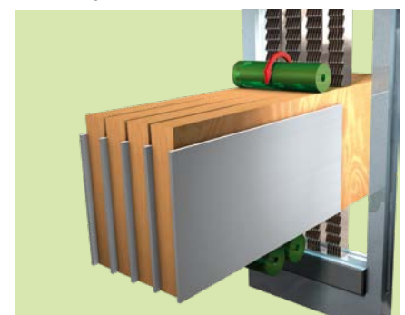
Kanaleinhang mit 4 Kanälen
