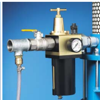
Die Wartungseinheit ist am Gerät installiert.
