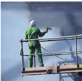
Beim Schiffbau ist die hohe Flächenleistung der WIWA MAGNUM Pumpen gefragt. Bei hohen Druckübersetzungen gibt es kaum Druckverluste über größere Distanzen.
