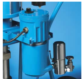
Der Materialerhitzer erwärmt das Spritzgut einfach und schnell.
