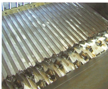
Segmentboden, für sehr dünnes Material (z.B. Furnier)
