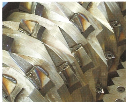
Zerkleinerer der Baureihe WL 10 - WL 30, einseitiger und doppelseitiger Antrieb
