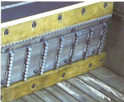
Zackenleiste an der Schublade, zum Festhalten des Materials
