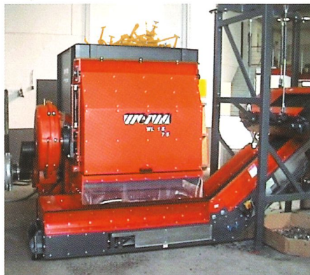
Zerkleinerer der Baureihe WL 15, Transportband mit Magnetabschalter
