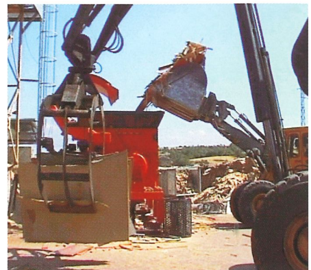
Zerkleinerer der Baureihe WL 20, Beschickung mit Radlader
