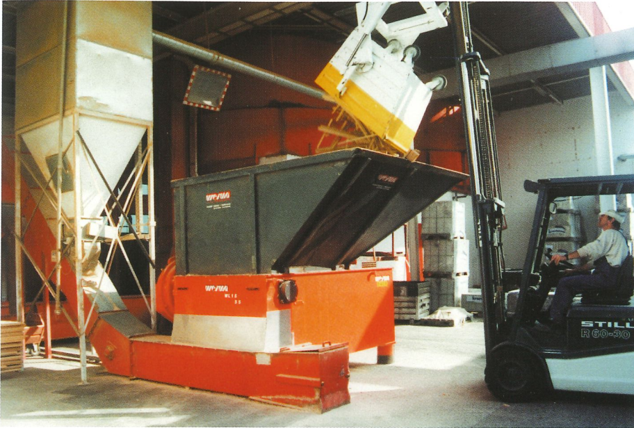
Zerkleinerer der Baureihe WL 15, Materialaufgabe mittels eines Gabelstaplers mit Abkippvorrichtung
