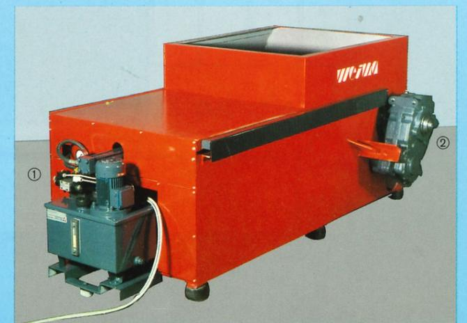
① Die Hydraulik steuert das Vorschubaggregat.
