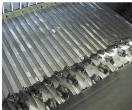
Segmentboden, für sehr dünnes Material (z. B. Furnier)
