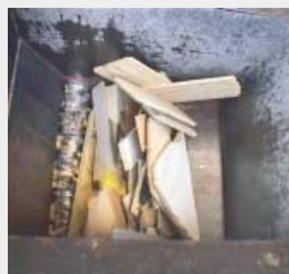
Arbeitsweise der Schublade, Andrücken des Materials gegen den Rotor
