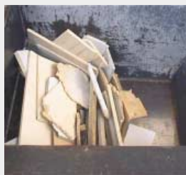
Arbeitsweise der Schublade, Andrücken des Materials gegen den Rotor
