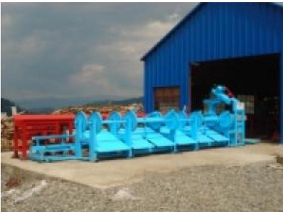
Säge-Linie Wravor Typ 1200 P-NB DOUBLE bestat aus Entrindungsmaschine für Stämme, Längsstehendes Stammtransporter und zwei Bandsägen, die auf linke und rechte Seite plasiert sind. Die Schnittkapazität ist cca. bis 80 m<sup>3</sup> auf 8 Arbeitsstunden.
