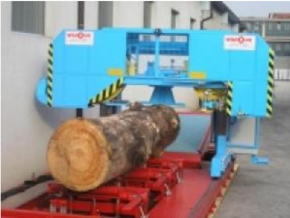
Säge-Linie Wravor Typ 1200 P-NB bestat aus Bandsäge Typ 1200 P-NB, Aufladerampe für selbstständige Stammaufladung und Brettausgangstrporter von die Bandsäge bis zum der nächste beliebig plasierte Maschine (Mehrblättrige Kreissäge, Besäumer oder Querkreissäge).
