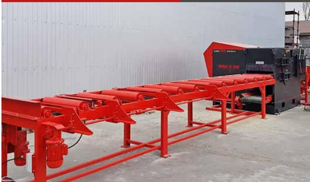
Questa linea automatica di seghe composta da seghe circolari multilama permette un'alta produttività in termini di tavole tagliate. Può essere montata come parte di una linea di seghe o autonomamente.
