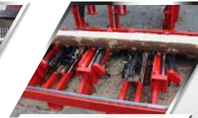
costruzione massiccia e resistente della guida realizzata con materiali perfezionati, torni mobili, supporti rinforzati, rulli mobili in verticale e orizzontale
