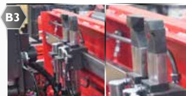
tenditore a due cilindri + elevazione idraulica dei perni
