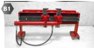
zacisk z jednym siłownikiem
