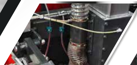
automatyczne smarowanie i czyszczenie
