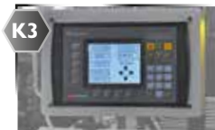
K3 automatyczny odczyt, programowane wprowadzanie wymiarów
