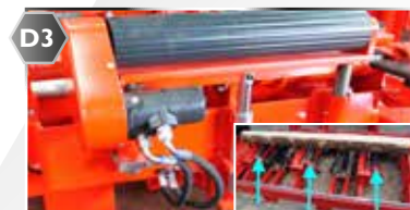
siłownik podnoszenia + przemieszczenia
