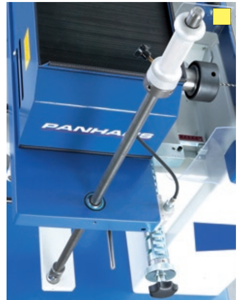
Einhebelbedienung mit Fernarretierung der Rasterwalze für komfortables Arbeiten
