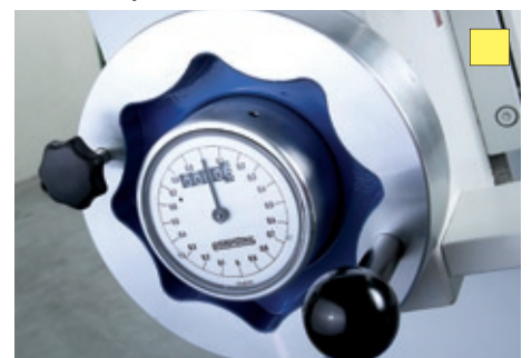
Messuhr im Handrad für die Höhenverstellung, Teilung 0,1 mm
