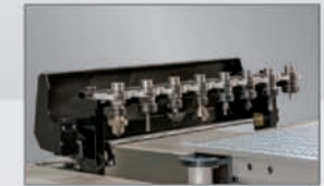
Sabit Takım Değiştirme / Linear Tool Changer
