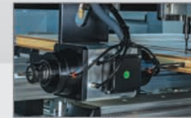
Menteşe ve kilit yeri açma özelliği (opsiyonel) Hinges and lock case processing feature (optional)
