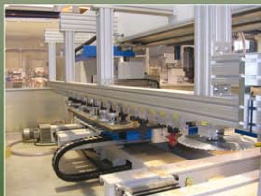
Elettromandrino in posizione di Cambio utensile Electrospindle in too-change position
