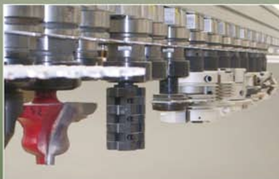
Elettromandrino in posizione di Cambio utensile Electrospindle in too-change position
