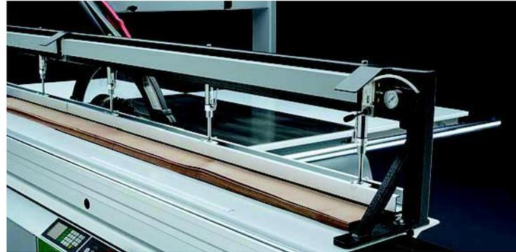
■ **Pneumatischer Druckbalken:** Zweigeteilt und getrennt steuerbar. Zum Spannen von Werkstücken bis 80 mm Dicke. Besonders vorteilhaft bei langen und dünnen Materialien wie z. B. Furnieren.
