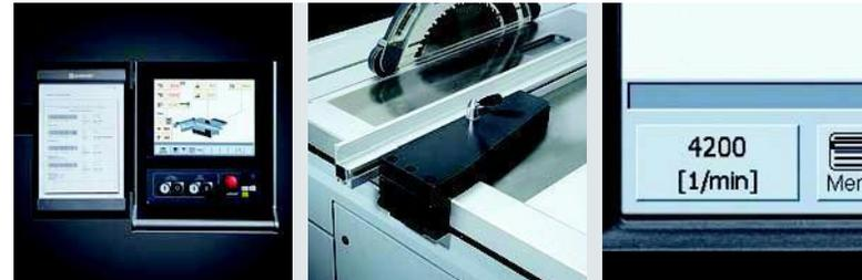
Die **F 45 ELMO III** überzeugt durch den großen 12" Touchscreen, über den die gesamte Maschine und die umfangreichen Anwendungsprogramme bedient werden.
