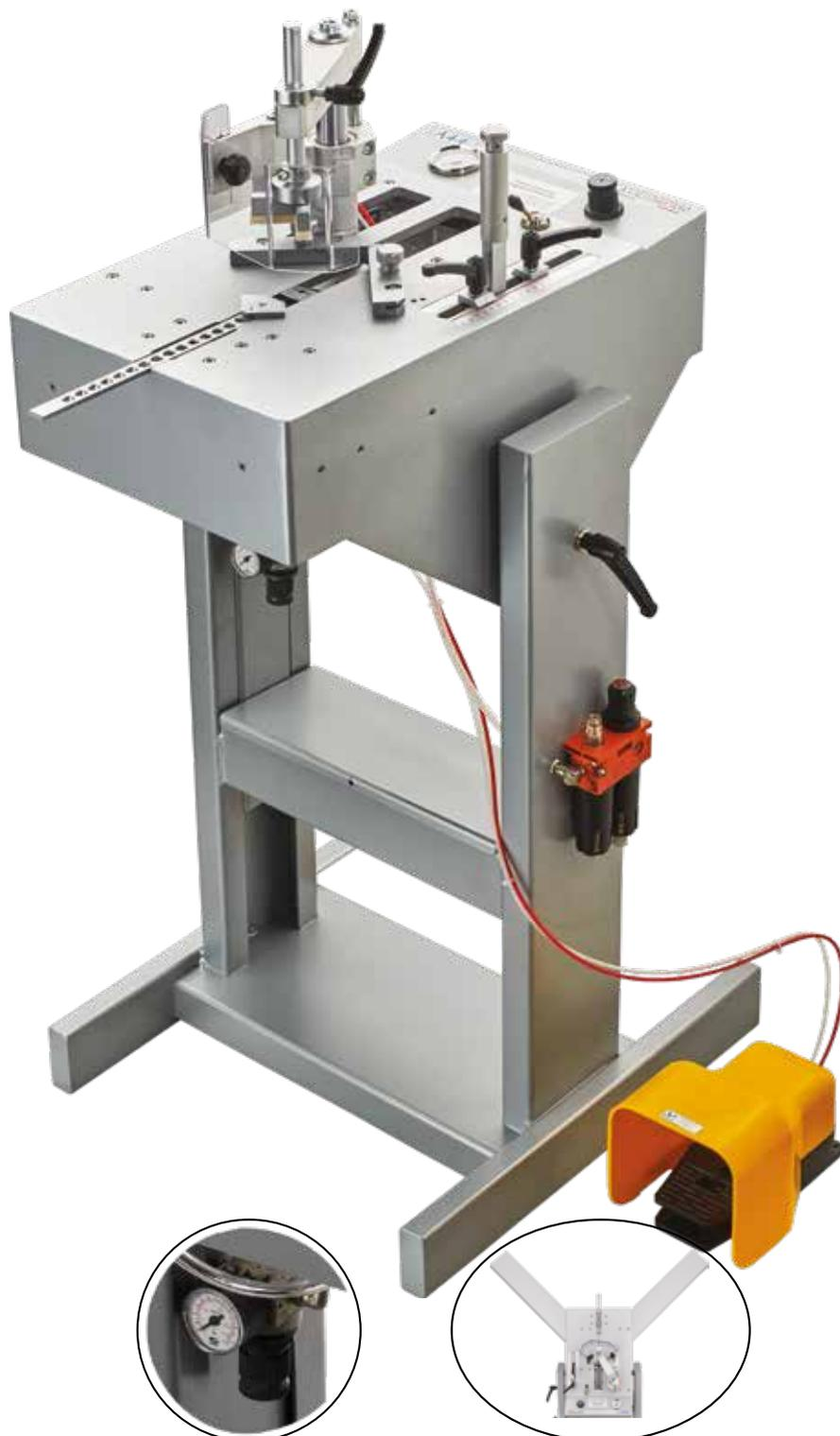
Cilindro di compensazione per alleggerire il gruppo di sparo quando si lavora in posizione inclinata
