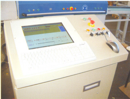
BL100A: Bedienpult mit IPC Steuerung BL100A: Operator panel with IPC control
