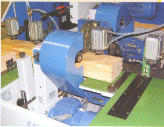
Vierfach Fräse für Eckverbindung "Chalet" Fourfold unit for cornerjoint "Chalet"
