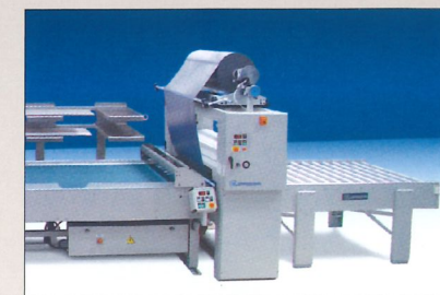
Desbobinador superior opcional. Option upper unwinding station.
