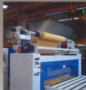
Desbobinador superior opcional. Option upper unwinding station.
