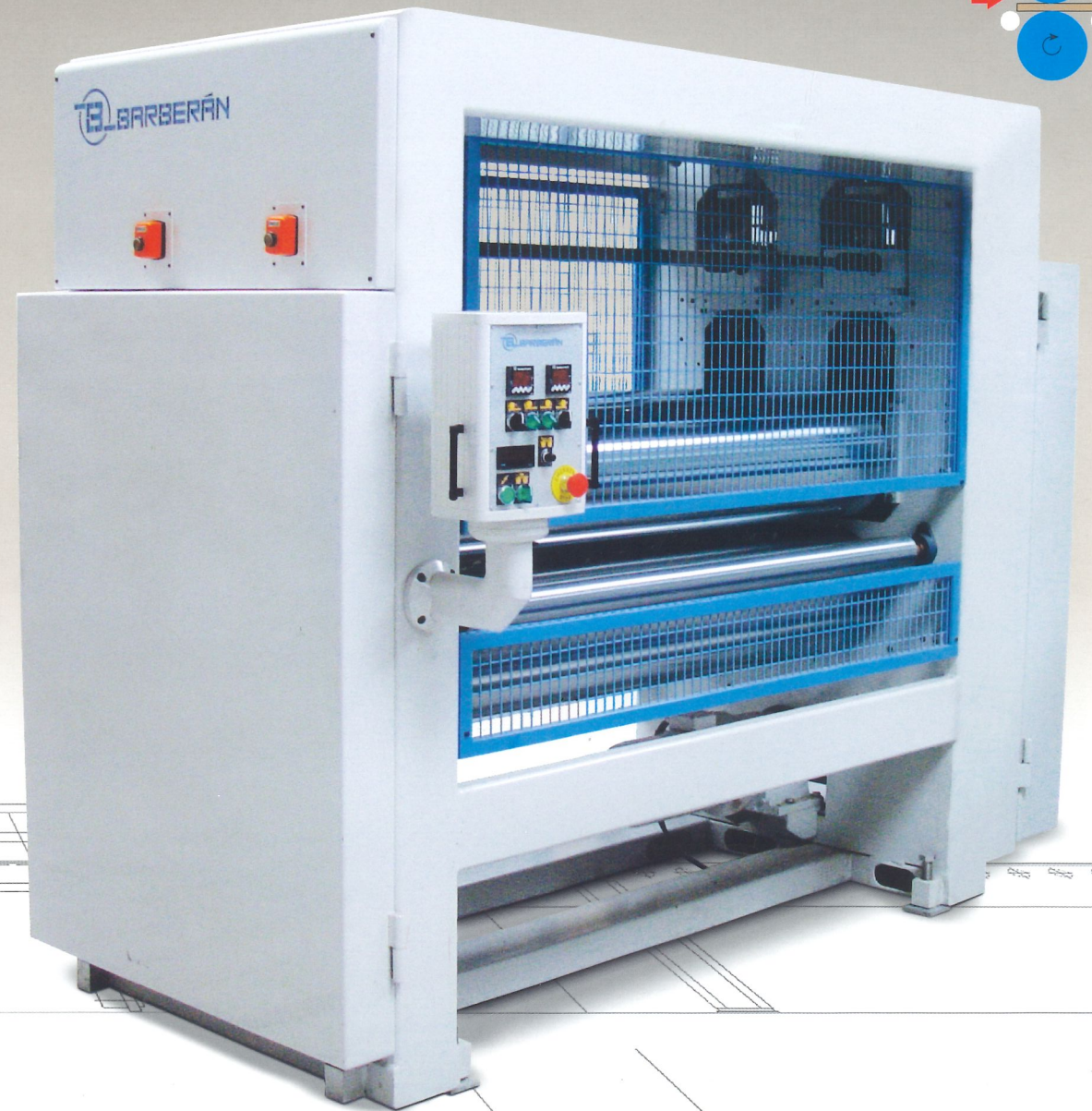
Elevación motorizada de los rodillos superiores con indicación en comparador analógico de precisión. Top rollers raising through motorized spindle with analogical comparator read out.
