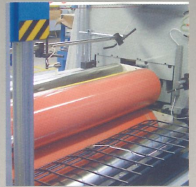
Sistema de limpieza con giro de los rodillos en sentido contrario al de aplicación. Cleaning system turning oppositely to the application sense.
