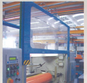
Protección superior con total acceso visual y preparada para extracción de gases. Upper protection with total visual access and prepared for gas extraction.
