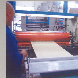
Encolado de las dos caras de los paneles. Gluing of both sides of the panels.
