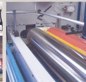
Rodillo dosificador metálico calefactado interiormente con aceite térmico. Metallic dosing roller with internal heating by thermal oil.
