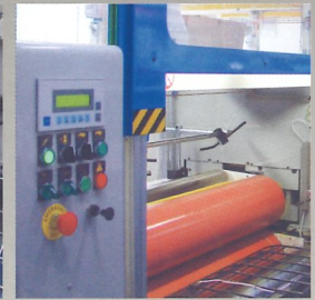
Ajuste del gramaje de cola a aplicar por variación de la velocidad del rodillo dosificador. Glue grammage adjustment by speed variation.
