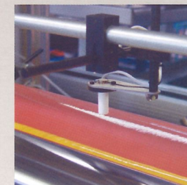
Detectores de nivel para el control del suministro de cola. Level detectors for the glue supply control.
