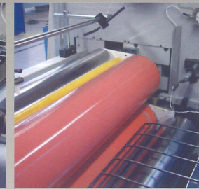
Rodillo aplicador recubierto de un elastómero. Applicator roller coated with elastomer.
