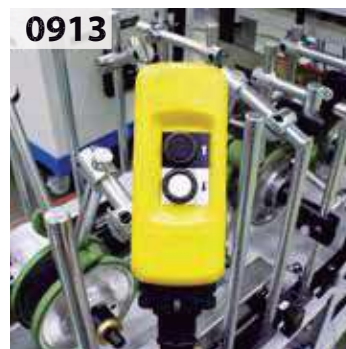
Auxiliary cable command for the control of the conveyor to facilitate the molding tools adjustment operations. Mando auxiliar con cable de 3 metros para el control de avance/retroceso del transporte en operaciones de ajuste.
