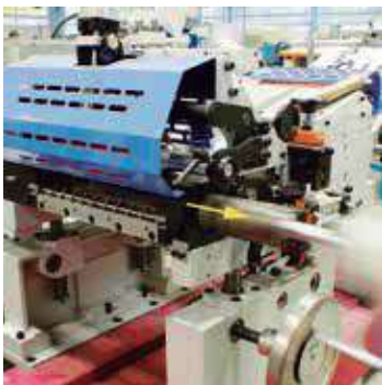
Applicator roller with fast disassembling. Rodillo aplicador de extracción rápida de segmentos. (PL)
