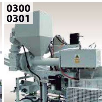
0300 0301 Extruder to supply premelted glue according to the gluing head requirements and type of glue.. Max 100kg/h. Extrusor sistema husillo para suministrar cola fundida según requiera el cabezal aplicador. Max 100kg/h. Según tipo de cola.
