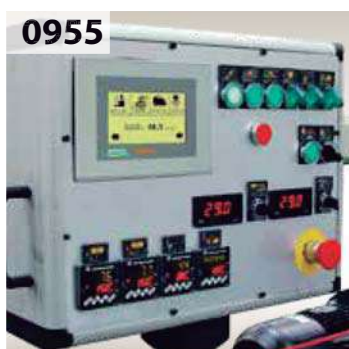
Centralised electronic speed control of several machines. Sistema de ajuste centralizado de la velocidad electrónica de varias máquinas.
