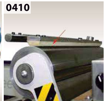
0410 Foil cleaning system before gluing. Sistema de limpieza del folio antes del encolado
