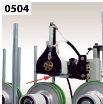
0504 Central milling unit with protection housing, to cut veneer. Fresa central con cabina de protección, para corte de la chapa en el galce.
