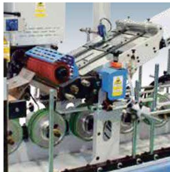
Roller hotmelt glue application head. Cabezal aplicador de cola termofusible sistema rodillo. (RP-30)
