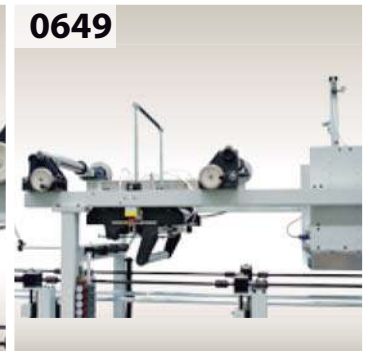
0649 Automatic splicing device for rolled veneer, with aluminum strips. Conjunto desbobinador con empalme automático para chapa de madera en bobina con junta de aluminio.
