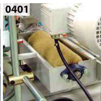
0401 Bottom cleaning brush, to remove the dust from the bottom of the profile. Cepillo de limpieza inferior, para la limpieza del dorso de la moldura.
