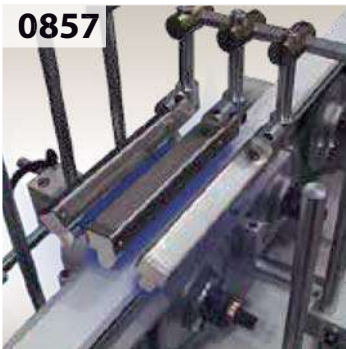
3 Black light lamps for the visual control of the "PRIMER" applied on the moulding. 3 Lámparas de luz negra para control ocular del "PRIMER" aplicado en la moldura.
