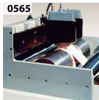
0565 Pvc foil surplus cut before gluing. Dispositivo para corte de saneamiento del folio de pvc antes de encolar.
