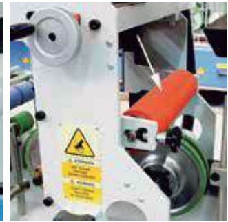
Adjustable first moulding roller. Primer rodillo moldeador ajustable en altura. (PUR)
