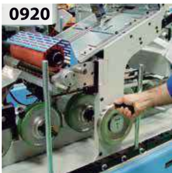
Hot melt coating head lifting system. Elevación cabezal aplicador cola termofusible.
