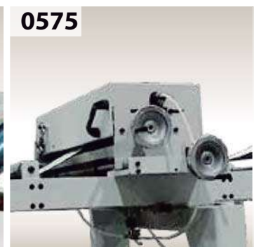
0575 Foil cleaning cut for PVC and paper foil with two pneumatic motors, before foil gluing. Corte del folio a medida con dos motores neumáticos antes del encolado.
