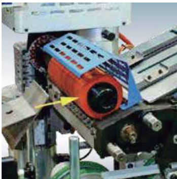
Pressure roller pneumatic control. Rodillo de contrapresión con mando neumático. (RP)
