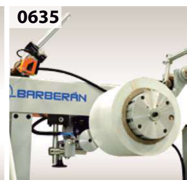
0635 Standard spool continuous automatic brake (magnetic powder) regulation. Regulación automática del freno (polvo magnético) de una bobina estándar.
