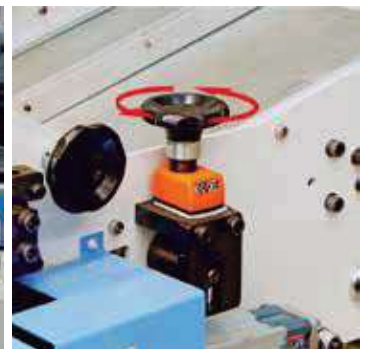
Hot melt dosing adjustment. Ajuste dosificación cola termofusible. (RP & PL)
