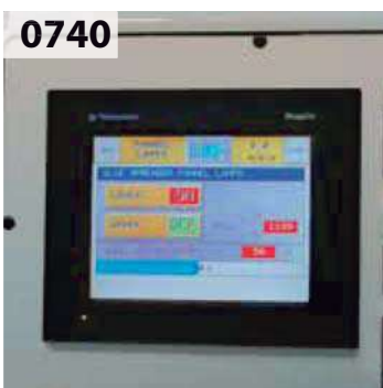
0740 IR lamps power regulation from the control board. Regulación de potencia de las lámparas IR desde el panel de control.
