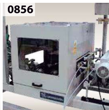
0856 PRIMER station safety housing. Cabina de protección de la estación de PRIMER.
