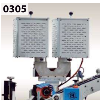
0305 Second glue preheating tank with unions. 2º depósito de pre fusión con uniones.
