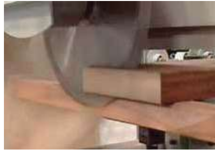
Max. Cut section Max. Sección corte: 400x80mm
