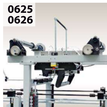
0625 0626 Automatic paper or PVC foil splicing for high speeds. Empalme automático de folio de papel o PVC para altas velocidades.
