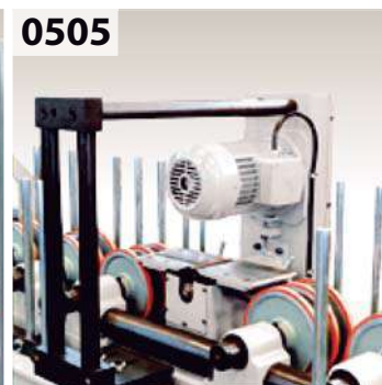
0505 Planing cutter (with protection) for flat base mouldings. Cabezal de cepillado inferior para molduras de base plana (con protección).
