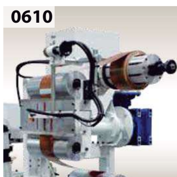
0610 Special unwinding unit for veneer spools with aluminum stripe joint. Desbobinador especial para bobinas de chapa con junta de aluminio.
