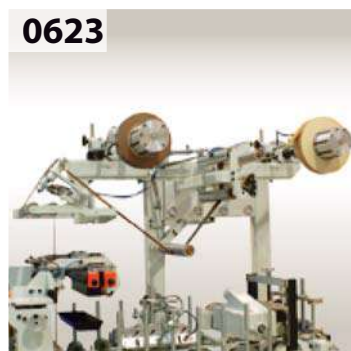
0623 Automatic paper or PVC foil splicing device. Empalme automático de folio de papel o PVC.
