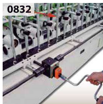
0832 Manual opening of the jamb wrapping tools. Abertura manual de las herramientas para ajuste del galce. Longitud del brazo, 1 metro.
