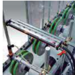
Deionizer for PVC profiles. Desionizador para perfiles de PVC.
