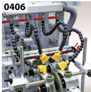
0406 Set of 4 air nozzles for profile cleaning Conjunto de 4 toberas para soplado de limpieza
