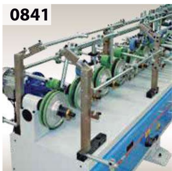
0841 Interchangeable 2 meters long tool-holder CASSETTE. CASSETTE portaherramientas partido, de longitud 2m.
