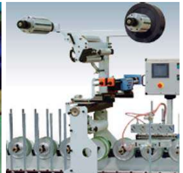
PUR hotmelt glue head, slot nozzle type. Cabezal aplicador de cola PUR sistema labio. (PUR)
