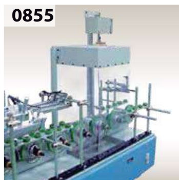
0855 PRIMER station with tank and applicators. Estación PRIMER aplicadores y deposito.
