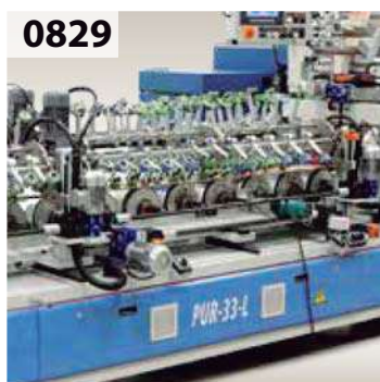
0829 Automatic revolver fast profile interchange system. Sistema de cambio rápido de perfil mediante revólveres automáticos.
