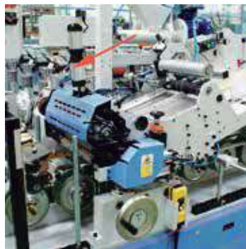
Counter-pressure roller pneumatically driven. Rodillo de contrapresión con mando neumático. (PL)
