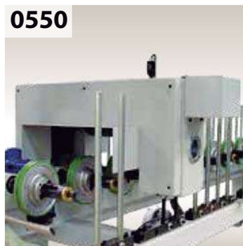
0550 Cutting blade between wrapped profiles. Cuchilla de corte entre perfiles recubiertos.
