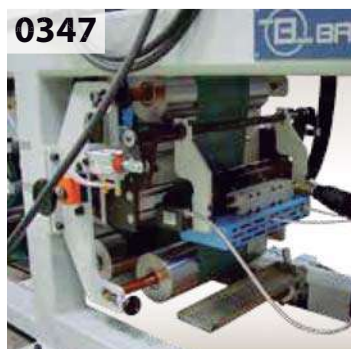
0347 Bottom support with uncoiling station and slot nozzle head. SopORTE inferior con eje desbobinador y labio laminador.
