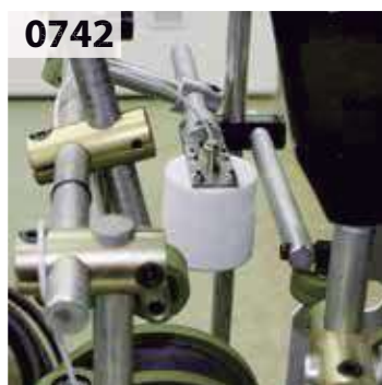
0742 Infrared foil heat detector. Detector de calor en el folio por infrarrojos.
