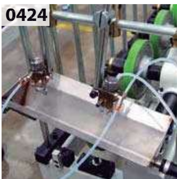
0424 Veneer steaming equipment. Equipo vaporizador para chapas frágiles.
