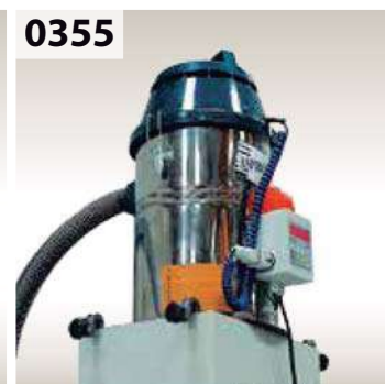
0355 Feeding system for hotmelt granulate to the extruder tank. Sistema de Alimentación de cola termofusible GRANZA, al depósito del inyector.
