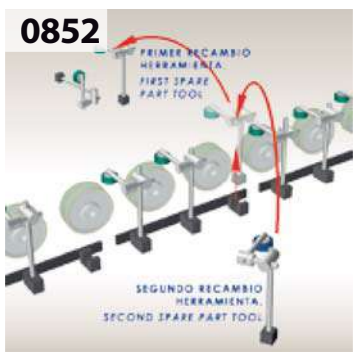
0852 Hydraulic system for a quick change of individual tools. Sistema hidráulico de cambio rápido de herramienta individuales.
