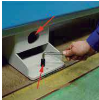
Housing to enable the loading and transport of the machine. Levelling system of the bedframe with key. Alojamiento para facilitar la carga y el transporte de la maquina. Sistema de nivelación de la bancada con llave suministrada.
