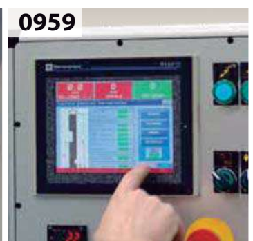
Cnc program for the automatic drawer side wrapping tools positioning. Programa cnc para el posicionamiento automático de las herramientas en el recubrimiento de laterales de cajón.
