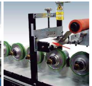
Adjustable first moulding roller. Primer rodillo moldeador ajustable. (RP & PL)
