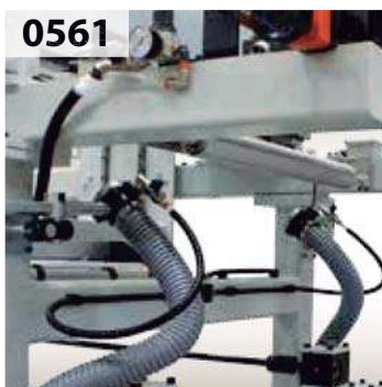
0561 Suction for foil waste removal (Venturi system). 2 Aspiraciones del folio sobrante (Sistema venturi).
