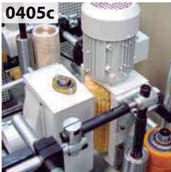
0405c Set of two vertical brushes for drawer-side surfaces. Conjunto de dos cepillos de limpieza para costados del cajón.
