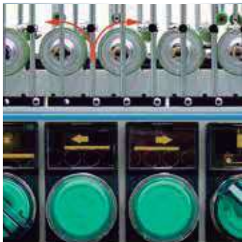
Transport forward and backwards to prepare the tools. Avance y retorcido del transporte para preparar las herramientas.
