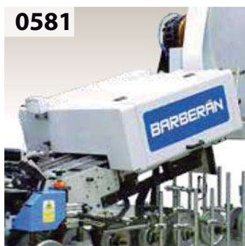
0581 This device cuts the veneer or CPL from the roll before gluing. Dispositivo para corte en continuo de chapa en bobina (o CPL) antes del encolado.
