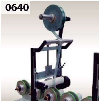
0640 Protection film unwinding station. Desbobinador para recubrir con film protector molduras recubiertas.
