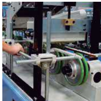
Fast adjustment moulding infeed guides. Guías de entrada de moldura de ajuste rápido.
