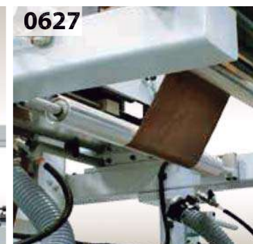
0627 Automatic tensioning system of the two spools for a constant tension. Sistema de tensado automático de las bobinas a tensión constante.
