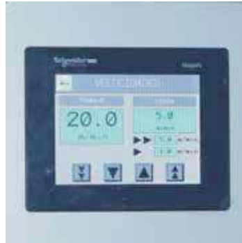
Electronic speed variation 10-60m/min. Variación electrónica de velocidad 10-60m/min.
