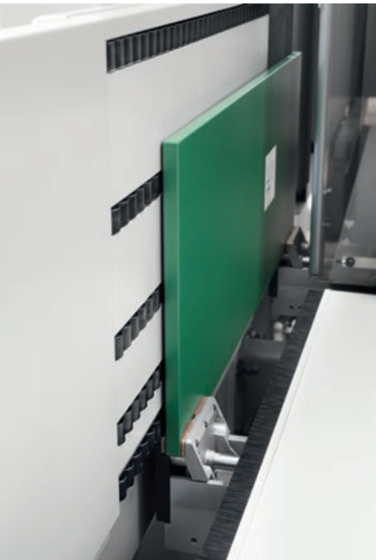
Werkzeugwechsler mit 8 Positionen zum Verwalten verschiedener Aggregate, um die Flexibilität der Maschine zu erhöhen.
