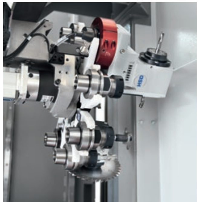
Werkzeugwechsler mit 8 Positionen zum Verwalten verschiedener Aggregate, um die Flexibilität der Maschine zu erhöhen.
