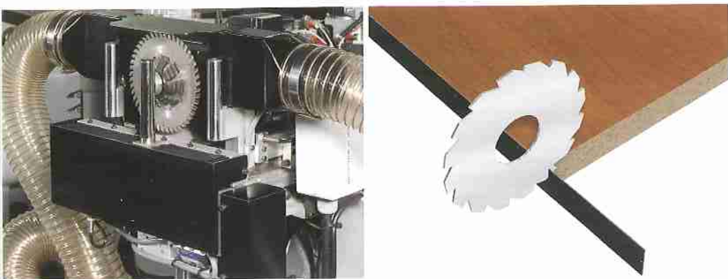
End-trimming unit and rounding unit. Coupe en bout et groupe arrondisseur.
