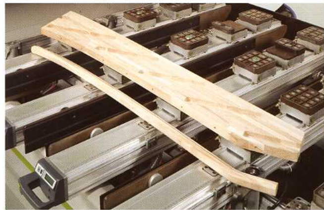
Machining of stair components Façonnage du limon et de la main courante
