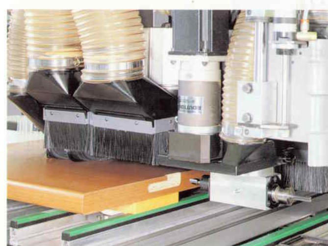
Angular head with 2 outlets for horizontal routing, assembled on the C axis, with 0°-360° rotation. Winkelkopf mit 2 Ausgängen für horizontale Fräsungen, in C-Achse 0-360° drehbar.
