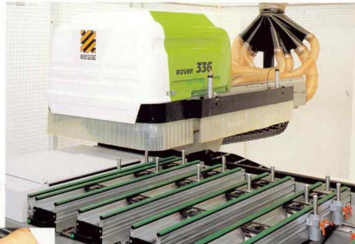
Double boring station for panels with reduced Y dimension (standard). Zweite Anschlagreihe für Werkstücke mit kleineren Abmessungen in Y (standard).
