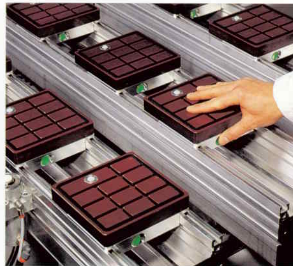
Universal jigs with pneumatic unclamping, for panels with different dimensions (optional). Vakuum-Schablonen mit pneumatischer Lösung für Werkstücke unterschiedlicher Abmessungen (optional).
