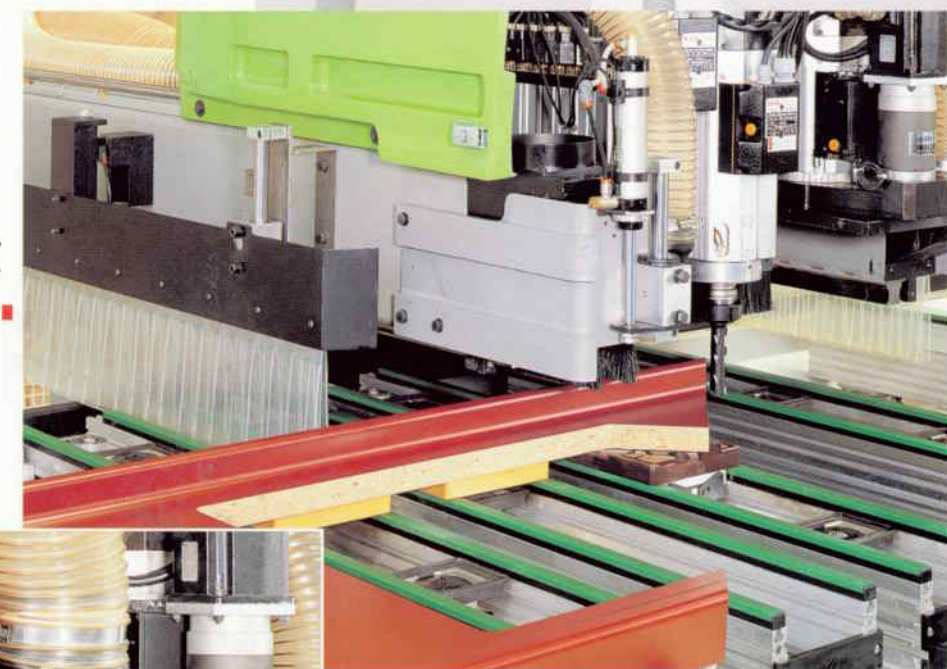
Working of kitchen tops. Bearbeitung von Arbeitsplatten für Küchen.
