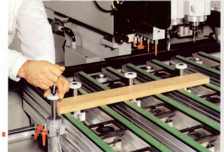
Device with double stop/clamp function for pneumatic clamping of narrow pieces (optional). Anschlagzylinder eingesetzt als Schmalteilspanner (optional).
