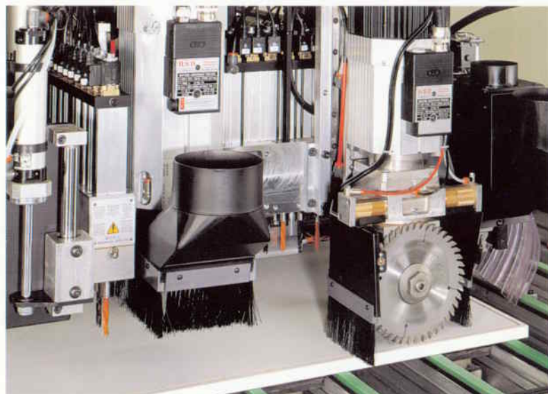
Grooving saw with N.C. automatic orientation from 0° to 90° and diameter 180 mm (optional). Schwenkbare Nutsägeeinheit, Sägeblatt-Durchmesser 180 mm (optional).
