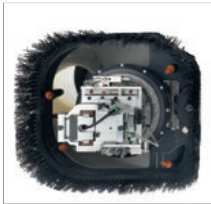
具有4个出风口的鼓风设备用于修边刀具组合
