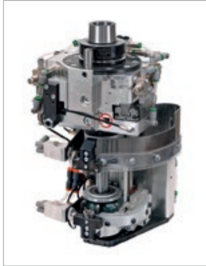
带分离剂送给功能的修边组合刀具
