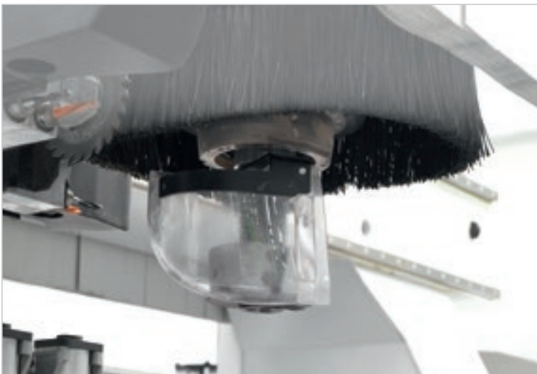
CNC-gesteuertes Späneleitsystem (Späneleitblech).
