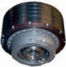
4-Achs-Fräseinheit mit einer Leistung bis zu 19,2 kW.
