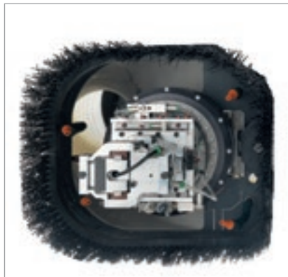
Ablaseinheit mit 4 Ausgängen, auch mit den Aggregaten für die Feinbearbeitung der Kante verwendbar.
