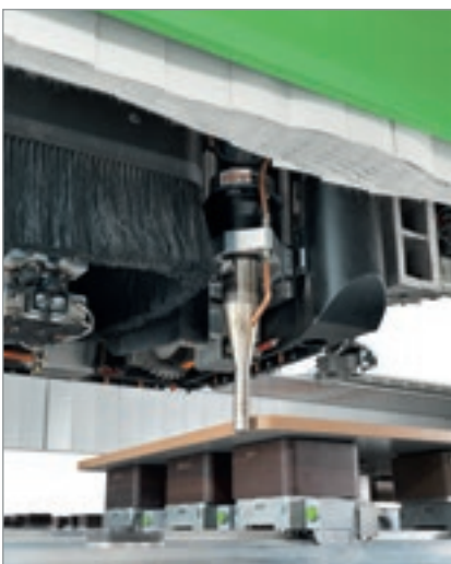
Abblaseinheit mit kalter oder warmer Luft.
