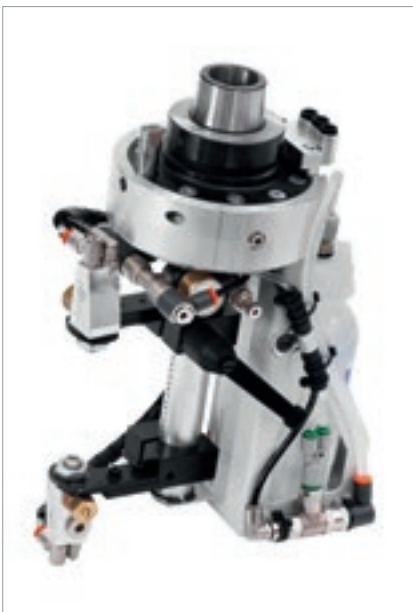
Gebläseaggregat und Trenmittelspender.
