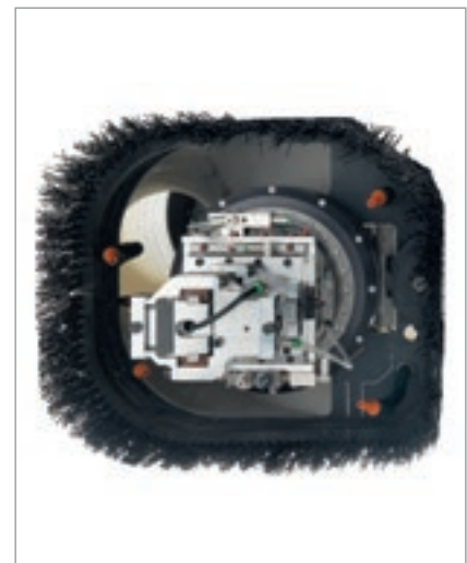
Abblaseinheit mit 4 Ausgängen, auch mit den Aggregaten für die Feinbearbeitung der Kante verwendbar.
