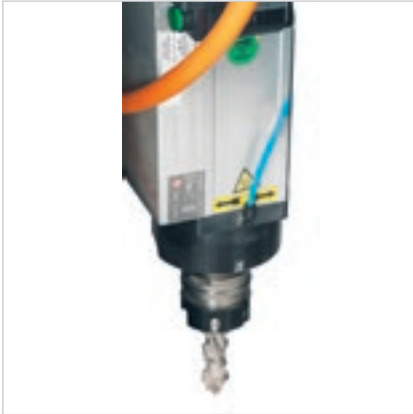
Motor vertical fijo dedicado a las operaciones accesorias de fresado (slot, antiastillas, ...).
