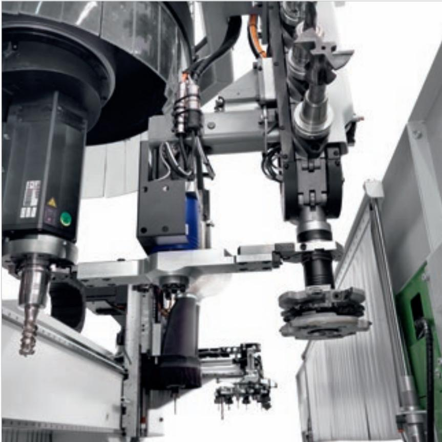
Grâce aux **axes Y indépendants**, il est possible d'effectuer des changements d'outils en temps masqué en utilisant le plus grand nombre d'outils disponibles sur la machine. La **navette** présente dans le magasin à chaîne verticale rend l'exécution du changement d'outil plus rapide.
