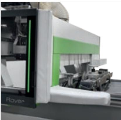
Sécurité et flexibilité grâce aux nouveaux bumpers associés aux photocellules sans encombrement à terre avec fonction pendulaire dynamique.
