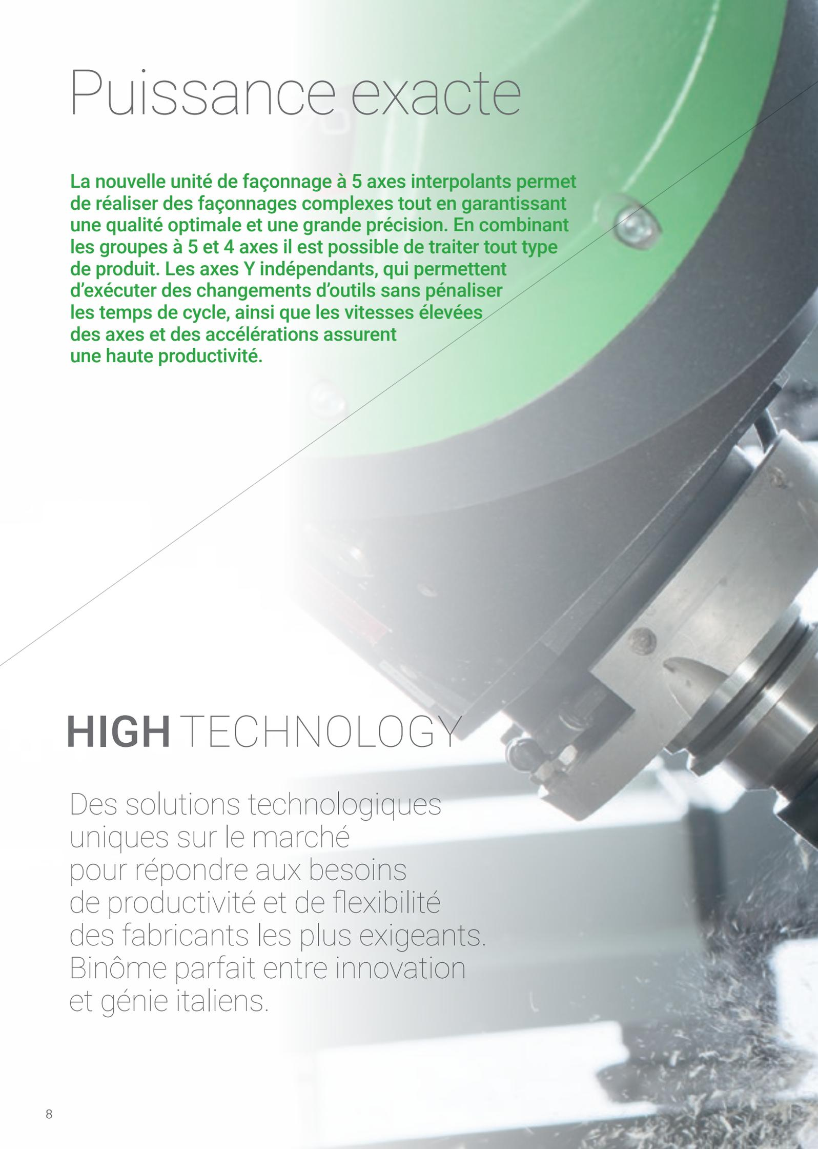
La nouvelle unité de façonnage à 5 axes interpolants permet de réaliser des façonnages complexes tout en garantissant une qualité optimale et une grande précision. En combinant les groupes à 5 et 4 axes il est possible de traiter tout type de produit. Les axes Y indépendants, qui permettent d'exécuter des changements d'outils sans pénaliser les temps de cycle, ainsi que les vitesses élevées des axes et des accélérations assurent une haute productivité.
