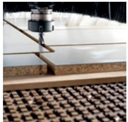
Deux machines en une : toutes les fonctionnalités et la qualité d'une vraie défonceuse sont garanties par le plan de travail **CFT (Convertible Flat Table)**, ce qui permet de réaliser des façonnages de panneaux minces, des Nestings et des Foldings sur une machine avec un plan à barres.
