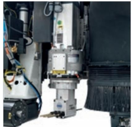
Le **groupe multifonction**, positionné en continu sur 360° depuis le CN, peut accueillir des agrégats pour l'exécution de façonnages spécifiques (logements pour serrures, logements pour charnières, perçage horizontal profond, coupe en bout, etc.).
