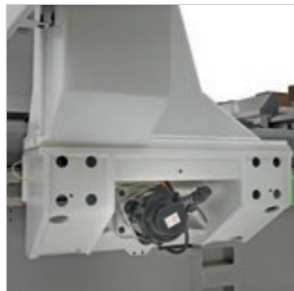
La **lubrification automatique** garantit une lubrification continue des principaux organes d'actionnement de la machine sans l'intervention de l'opérateur.
