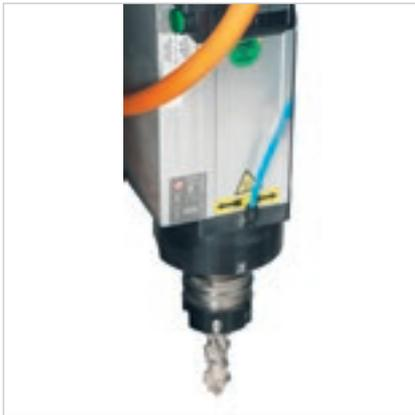
**Moteur vertical fixe** spécifique consacré à d'autres processus de fraisage (slot, anti-éclats, ...).
