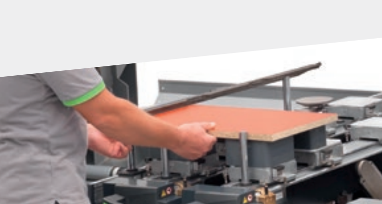
Sistemas de sujeción con vacío .
