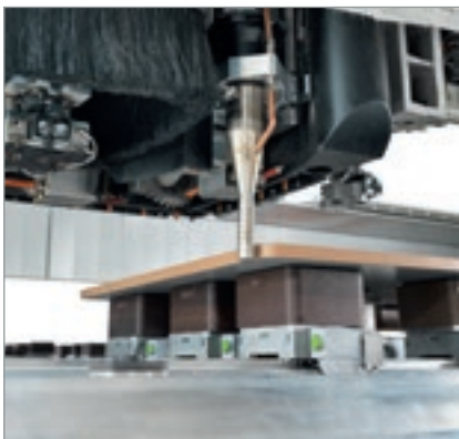
Grupo soplador de aire frío o caliente para reavivar el color del canto.
