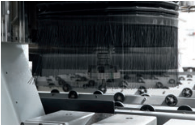
Caixa de aspiração com 6 posições de regulação.
