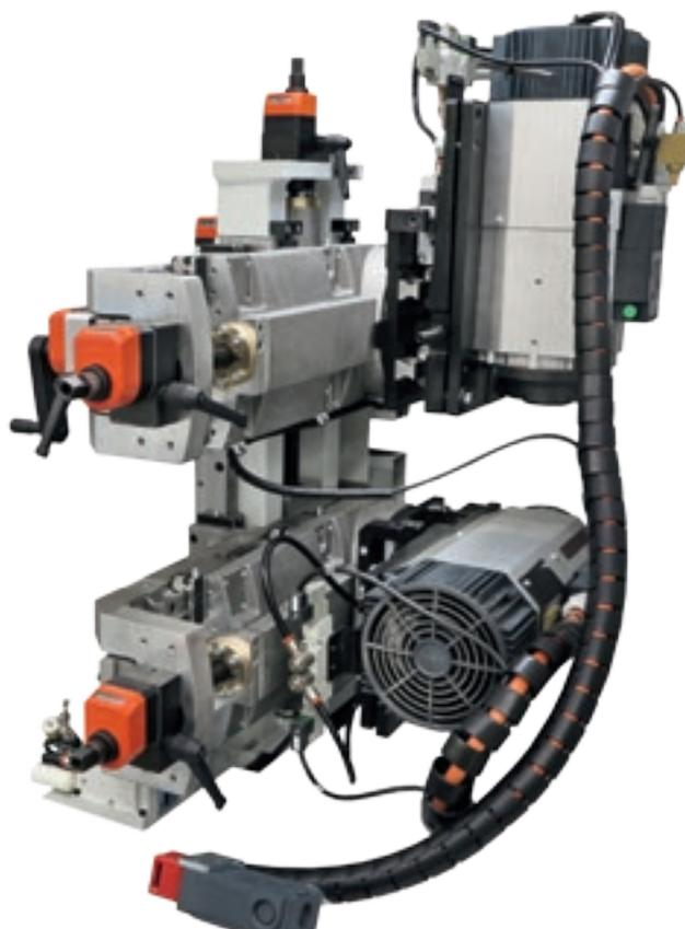
**EL GRUPO FRESADOR PERMITE REALIZAR EL RANURADO Y EL FRESADO EN LA SUPERFICIE INFERIOR, SUPERIOR Y FRONTAL DEL TABLERO.**
