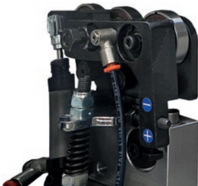
El **Grupo Raspador de Cola** para retirar los sobrantes de cola en la parte superior e inferior del tablero es el único dotado de 4 cilindros neumáticos que ofrece una alta calidad de acabado.
