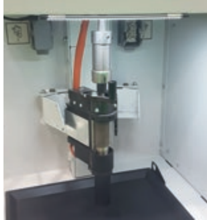
gPod Biesse Vorrichtung für Polyurethan-Leim mit System "PUR on demand" für das Schmelzen in Echtzeit von nur der Menge, die notwendig ist.
