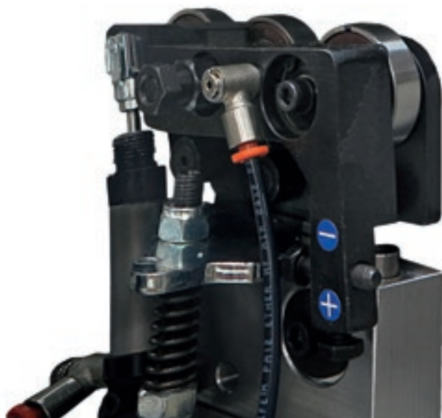
Il Gruppo Raschiacolla per rimuovere gli eccessi di colla nella parte superiore ed inferiore del pannello, è l'unico sul mercato dotato di 4 cilindri pneumatici per un'elevata qualità di finitura.
