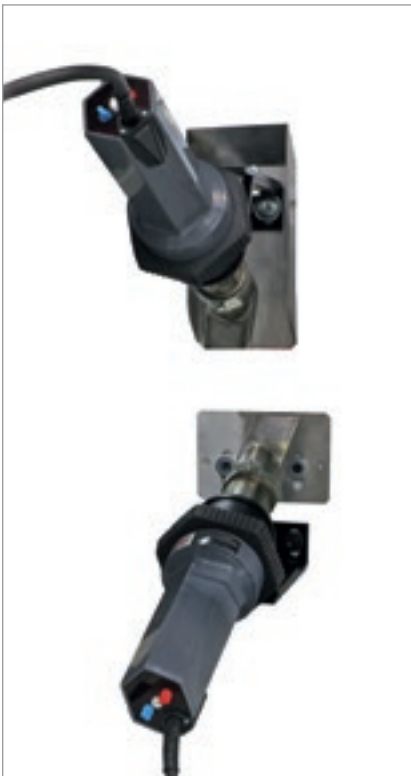
Heißluftaggregat für die Reaktivierung der Kantenfarbe.
