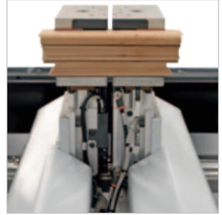
Le particolari forme delle morse consentono di bloccare anche pezzi corti con due morse Finger.
