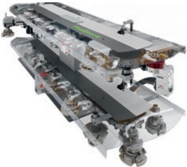
Almacén flexstore con 44, 66 y 88 posiciones con entreje de 180 mm.
