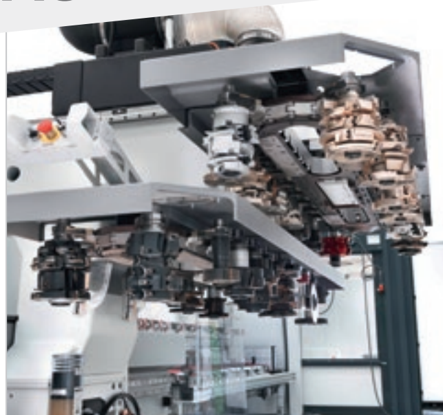
Depósito de corrente de nível duplo com 44 posições totais.
