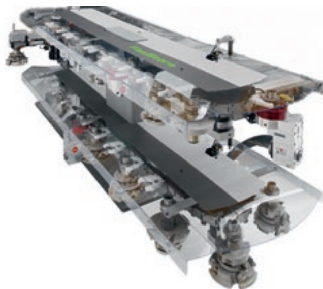
Depósito flexstore 44, 66, 88 posições e distância entre eixos de 180 mm.
