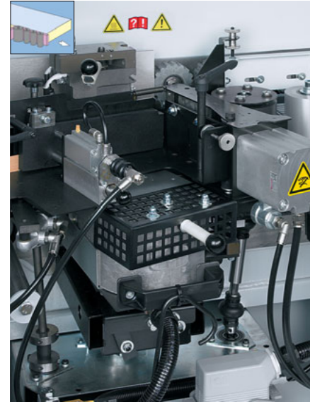
Verleimaggregat und Magazin Rollen- und Fixlängenmagazin für eine sichere Materialzufuhr. Optimale Leimfugen dank feinsten Dosierbarkeit.
