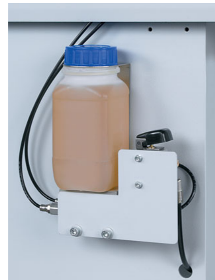
Zentral-Schmiereinheit (optional) Schmierung der Kettenbahnführung mittels Handtaste für einen langlebigen und präzisen Lauf der Transportkette.
