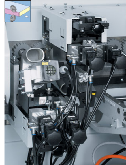
Fräsaggregat mit pneumatischer 3-Punkt-Verstellung (optional) Für eine noch effektivere Produktion und eine deutliche Zeitersparnis bei der Umrüstung.
