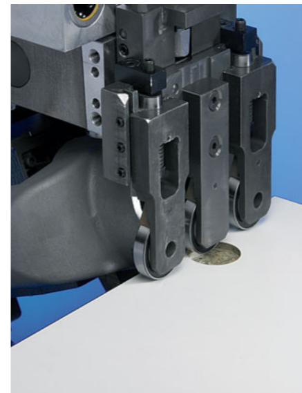
Nesting Paket (optional) Bestehend aus einer Mehrfach-Tastung auf Fräs- und Ziehklingenaggregat zur Überbrückung von z.B. Topfbandbohrungen.
