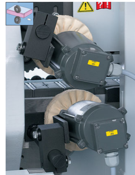
Schwabbelaggregat Zum Polieren von Kanten für natürliche Farbtöne.
