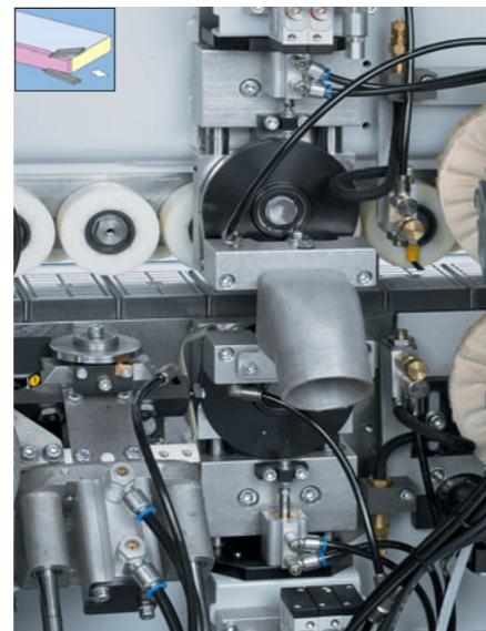
Leimfugenziehklingenaggregat (optional) Für das perfekte Finish und eine Materialabnahme bis zu 0,3 mm.
