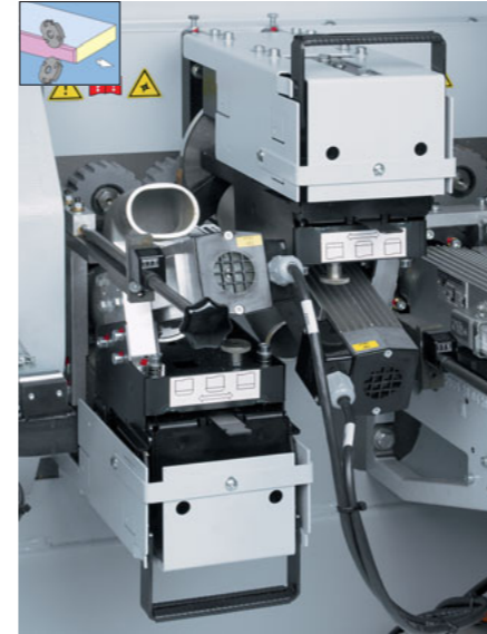
Fräsaggregat Multifunktionales Fräsaggregat mit DFC Werkzeugtechnologie (Dust Flow Control) für eine optimale Absaugung.
