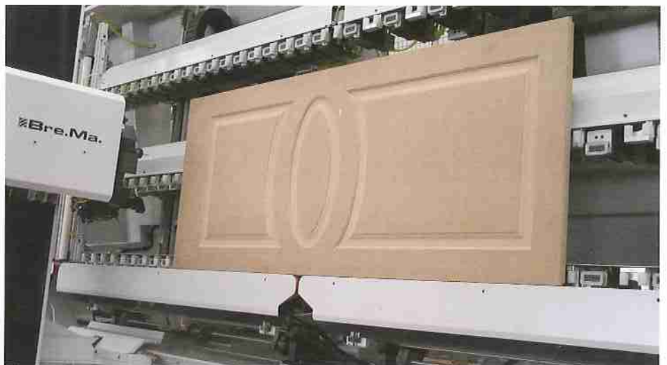
Usinage complet et équarrissage de la face principale de la porte.
