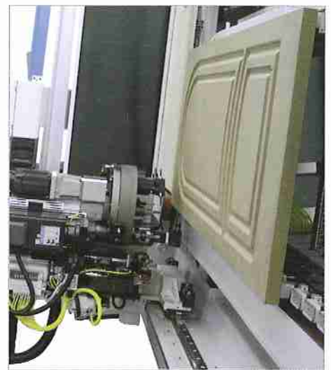
Usinage côté inférieure d'une porte.
