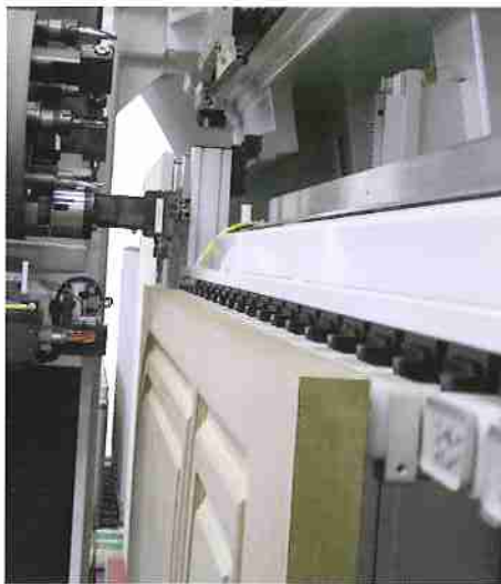
Usinage côté supérieure d'une porte.
