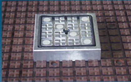
Esempio di ventose in alluminio. Example of aluminium suction cup. Exemple de ventouse en aluminium. Beispiel eines Aluminiumsaugnapfs. Ejemplo de ventosa de aluminio.
