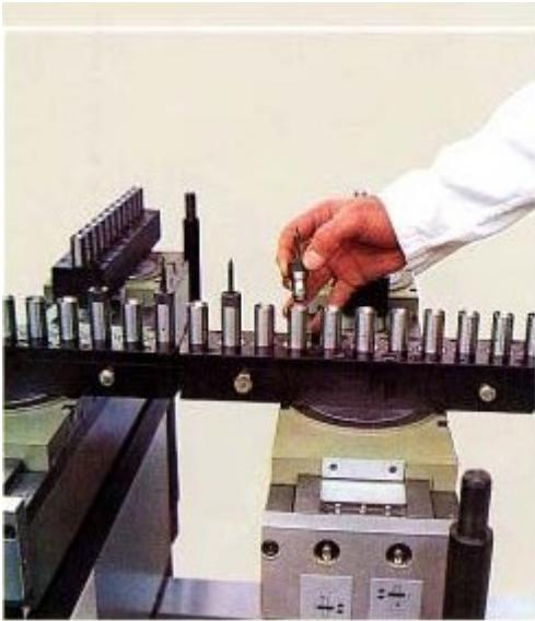
Mandrino porta punta rapido mod. Quickly a guidaggio conico autocentrante.
