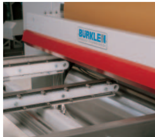
Kettentransport mit umlaufenden Transportkernen Chain transport system with circulating transport cones
