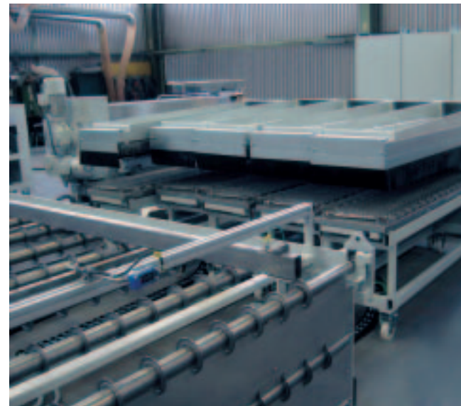
IR-Zone (ausfahrbar) zur Plattenvorwärmung IR zone (retractable) for preheating the boards
