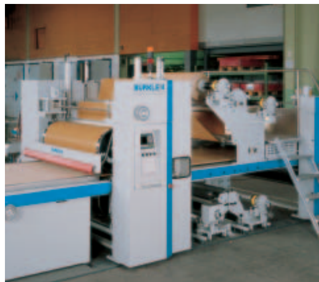
Kaschierstation mit großen beheizten Stahlwalzen Laminating station with large heated steel rollers
