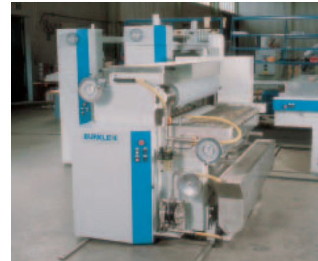
Härtermaschine in ausgefahrenem Zustand Hardener applying machine being withdrawn
