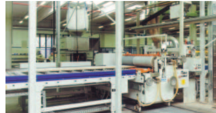
Leimauftragmaschine Glue spreading machine
