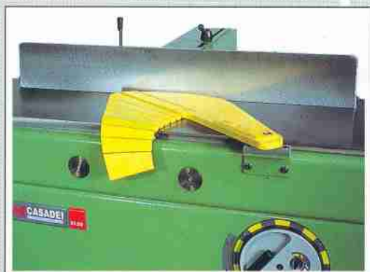
Protezione a normativa tedesca Protection selon normes allemandes Schutzvorrichtung gem. deutscher Vorschrift
