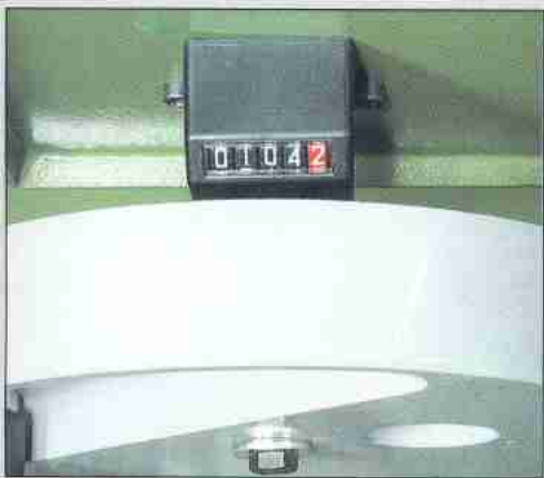
5 -Indicatore numerico decimale per la corsa verticale del mandrino
