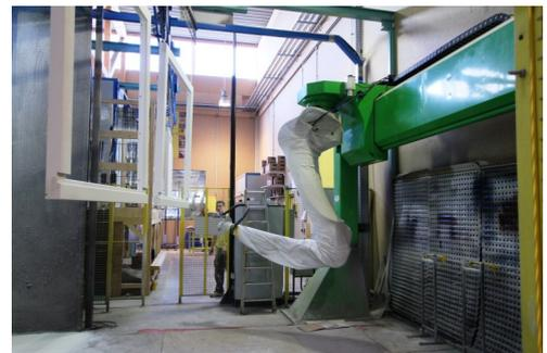
Ist es erforderlich den Arbeitsbereich zur Beschichtung von sehr großen Werkstücken zu erweitern, dann kann der Roboter auf eine stehende oder hängende Verfahrachse gesetzt werden.
