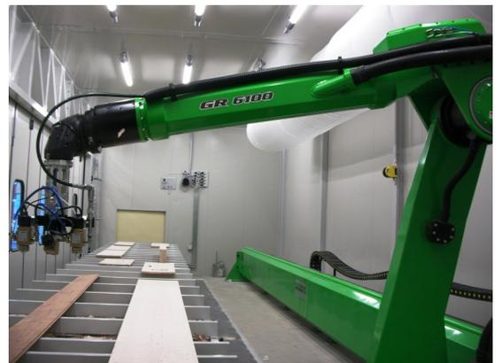
Durch den gleichzeitigen Einsatz von bis zu drei Lackierpistolen kann bei gleichzeitigen Betrieb die Flächenleistung erhöht werden und im Einzelbetrieb mehrere Farbtöne vorgehalten
