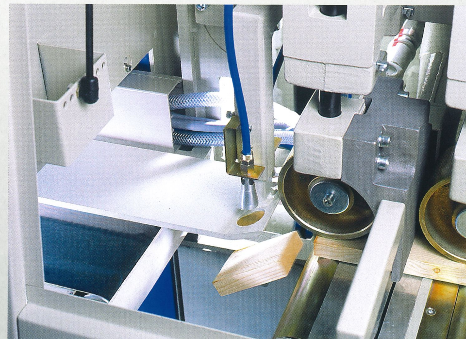
Die hundertprozentige Abfallsorgung durch den patentierten Abfallschacht garantiert Produktionssicherheit im nachfolgenden Sortiervorgang
