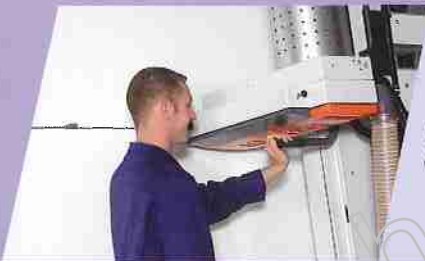
3 • Streifenmaß sägen unter Zuhilfenahme von Keilen um die Schnittfuge frei zu halten
