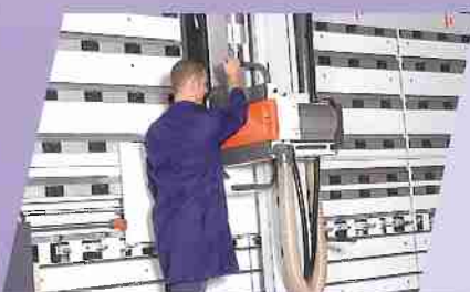
7 • Nun wird der Streifen in Kassetten aufgeteilt
