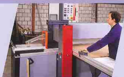
8 • Auch bei horizontalen Plattenaufteilsägen werden Streifen abgenommen und zwischengelagert
