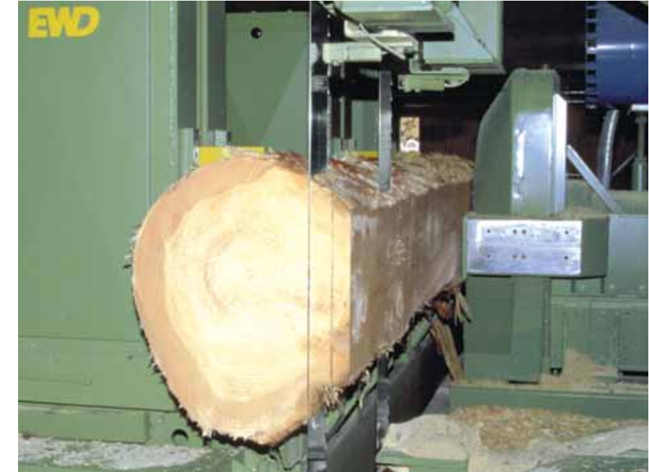
Vorschnitt mit T-EBB und Spaneraggregat PF19
